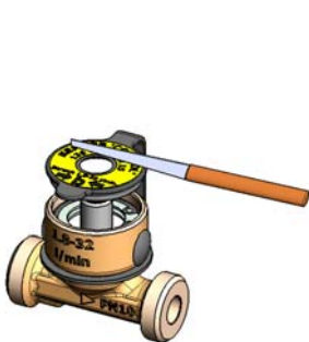
1. Kappendom abschneiden 1. Cut off the cap dome
