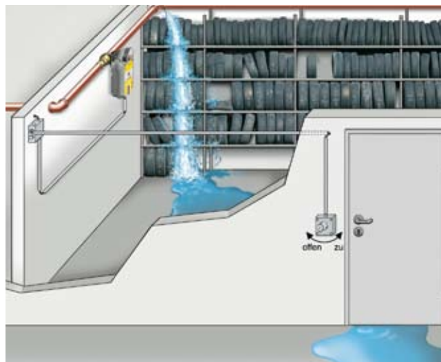
Uzavření khs-vav-plus při zamknutých dveřích pomocí uzamykatelného vypínače
