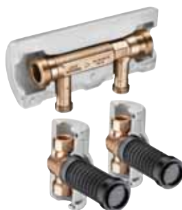
2. Skupina Venturiho děličů průtoku KHS DN 15 - DN 32 k montáži pod omítku v úseku mokré buňky, kompletní s děličí průtoku KHS, uzavíracími ventily úplného proudu KHS-VAV a izolačním pouzdrzem Figura 640 00/01/03/04
