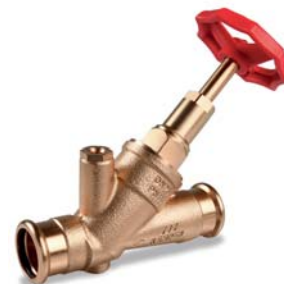
WESER Freistrom-Absperrventil mit festem Pressanschluss System Geberit MAPRESS für Edelstahl- und Kupferrohr, mit Entleerstopfen Figur 190 22
