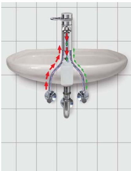
Probenahme an der Entnahmearmatur. Bei einer mechanisch voreingestellten Armatur kommt es immer zu einer Beimischung.
