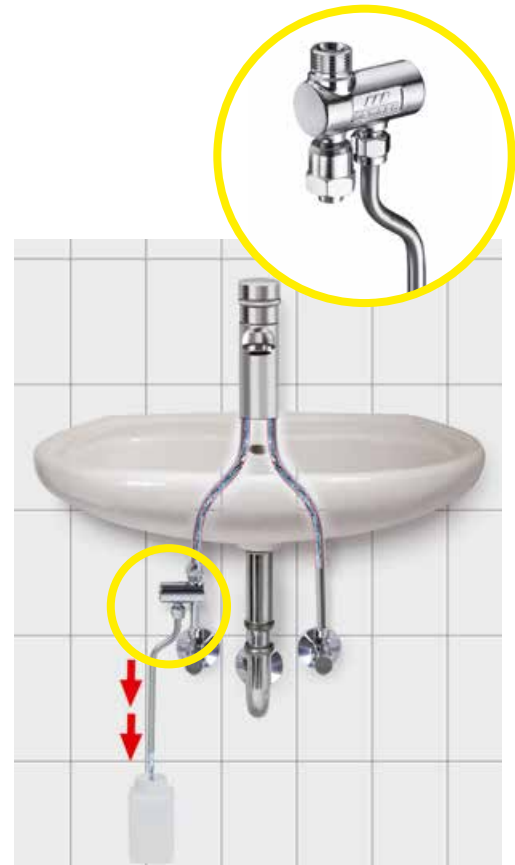
Probenahme mittels KEMPER Probenahmeventil mit integriertem Rückflussverhinderer unter einem Waschtisch. Rückfließen oder Überströmen von PWC nach PWH ist ausgeschlossen.
