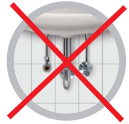
2. keine Demontage des Eckventils
